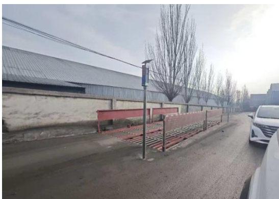
车辆清洗及沉淀池
